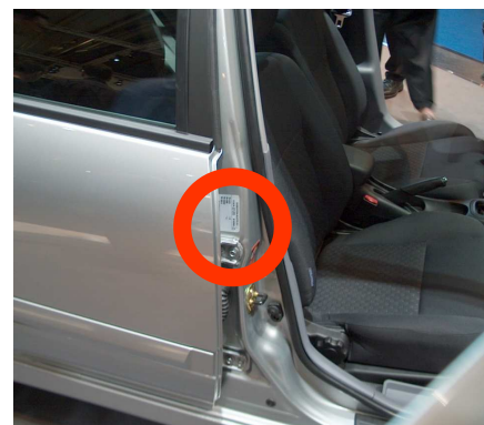
VIN PLATE POSITION ALMERA
